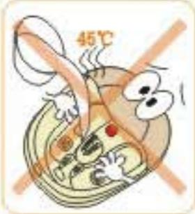
请勿将45℃以上热水直接倒入盆体内使用，以免引起脚部烫伤或使产品高温变形。
